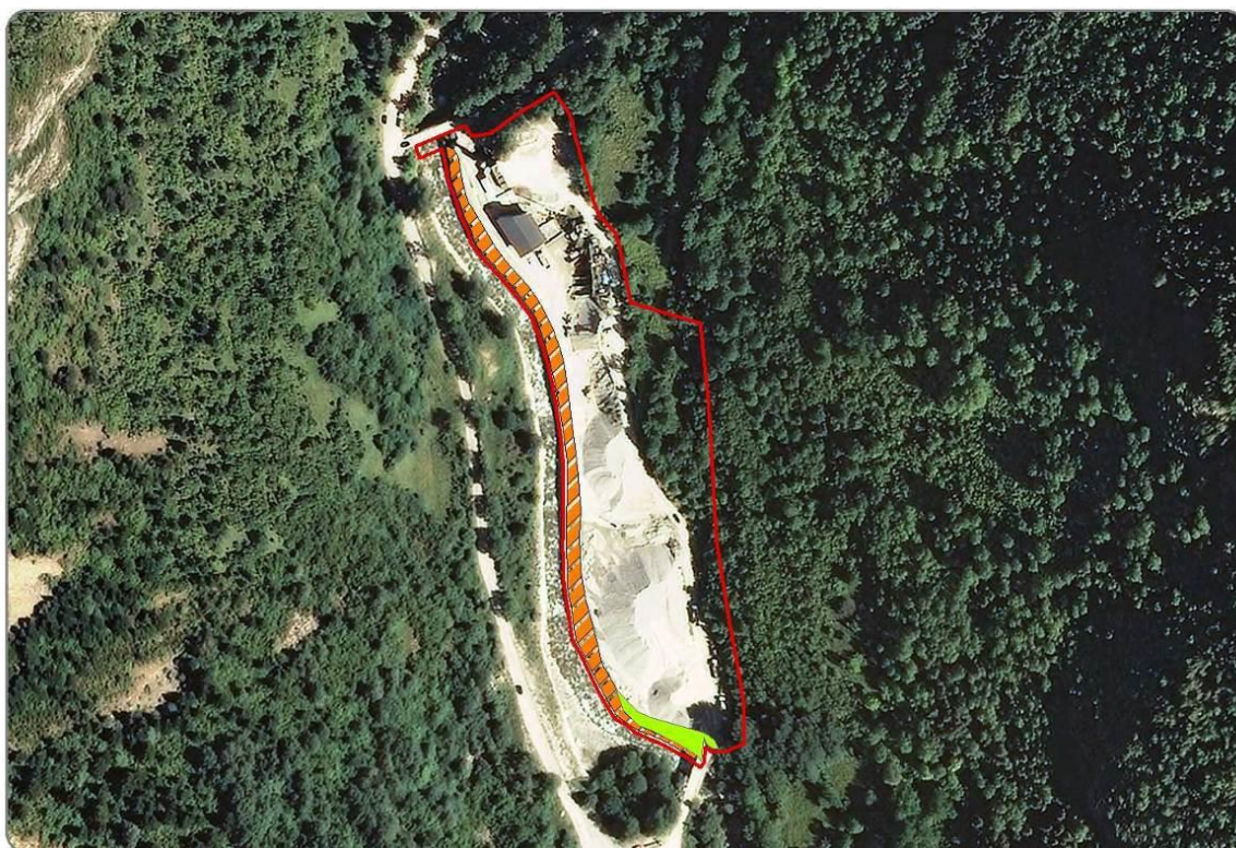
Foto 15. El riu Valarties, en sentit N-S, amb l'escullera de protecció que es va construir fa alguns anys. S'observa que la diferència aproximada de cota entre la llera i l'àmbit és de 5 m. S'observa també la protecció sobre la rasant de l'àmbit amb peces prefabricades tipus New Jersey.
